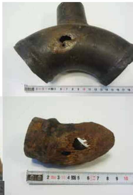
Primeri razpadlih cevi, ki niso bile katodno zaščitene
