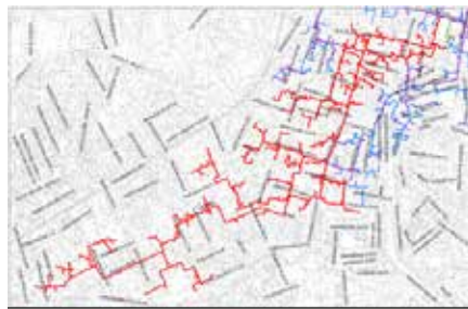
Slika 2 – Izločen del vročevoda ob izvedbi vzdrževalnih del v kolektorju Slovenska (rdeče)
