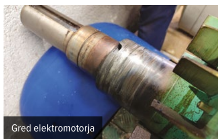
Montaža elektromotorja v ohišje kompresorja.
