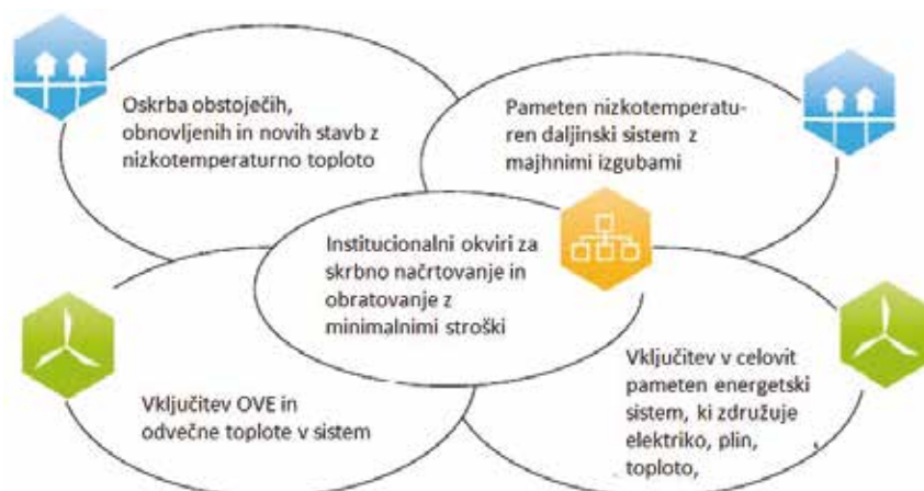
Slika 2: Ponazoritev koncepta 4. generacije sistema daljinskega ogrevanje (vir: www.sciencedirect.com)
